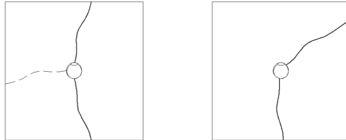
Рис. 2. Схемы разрушения бетонных кубиков
