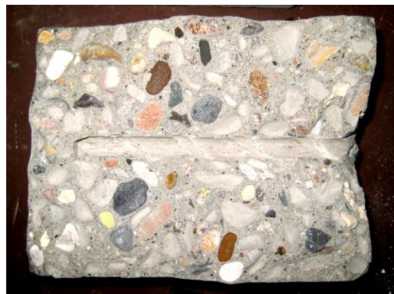
Рис. 3. Расколовшийся образец с очертаниями отверстия, занимаемого арматурой
